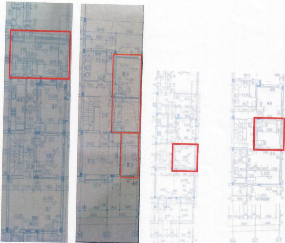
嘉定区洪德路 333 弄 113 号搭建情况：1.一层北侧入户院子封闭搭建房屋，长约 6.3 米，宽约 2 米，面积约 12 平方米。2.东侧内院部位封闭并向上扩建第 3 层，每层长约 3.6 米，宽约 3.6 米，面积约 12.96 平方米，砖混结构。3.三层东南侧露台搭建房屋，长约 4.8 米，宽约 1.9 米，面积约 9.12 平方米，砖混结构。4.上方搭建阳光房，长约 2.4，宽约 1.9 米，面积约 4.56 平方米，玻璃框架结构。5.三层东北侧露台搭建房屋，长约 4.2 米，宽约 2.9 米，面积约 12.18 平方米。
